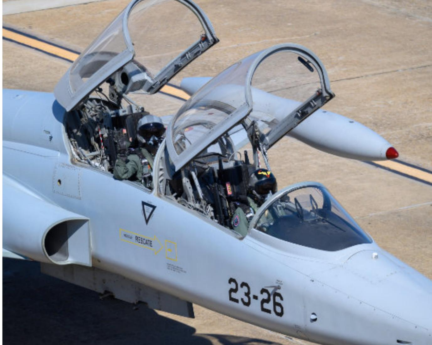
d'Albacete. Après 1 000 heures de vol, une révision majeure est effectuée et implique un examen complet de l'avion et de ses systèmes intégrés. Au cours de cette révision, l'avion entier est démonté et l'intégralité de la cellule est examinée, vérifiée pour les fissures métalliques et tous les systèmes sont testés. Après le remontage de l'avion, il doit passer le test d'acceptation qui est effectué par un pilote instructeur expérimenté d'Ala23.
