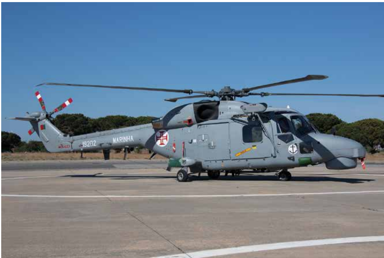
Los Super Lynx MK95A cuentan con los nuevos motores LHTEC CTS800-4N.
